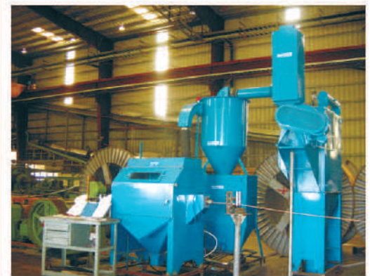
Special equipment to increase adhesion of insulation for ABC Cable Thiết bị làm tăng độ bám dính của cách điện cho cáp ABC
